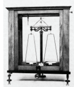
Abb. 1: Ungedämpfte, ausarmige Analysenwaage. A. Sauer, Kilmgen, 1935.
